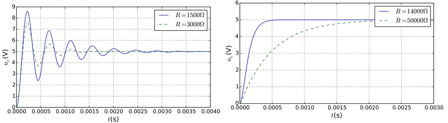
FIGURE 2 – Simulations d'évolutions de la tension aux bornes du condensateur, pour différentes valeurs de résistance, avec  $C = 10 \text{ nF}$  et  $L = 0,5 \text{ H}$ .
