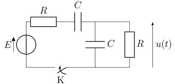
Q1. Établir l'équation différentielle vérifiée par la tension  $u$  et montrer qu'elle s'écrit sous la forme
