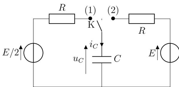
FIGURE 1 – Schéma de recharge d'un condensateur
