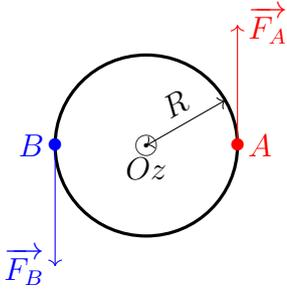
Résultant des forces s'exerçant sur le volant :  $\vec{F} = \vec{F}_A + \vec{F}_B = \vec{0}$ , car les deux forces sont opposées.
