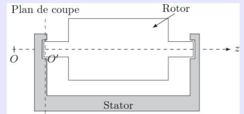
La liaison pivot peut être réalisée en emboîtant deux cylindres sur le même axe et en réalisant des butées pour empêcher les cylindres de coulisser le long de leur axe commun.
