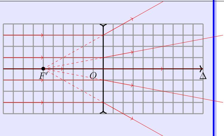
On appelle **plan focal image**, le plan perpendiculaire à l'axe optique passant par  $F'$ .
