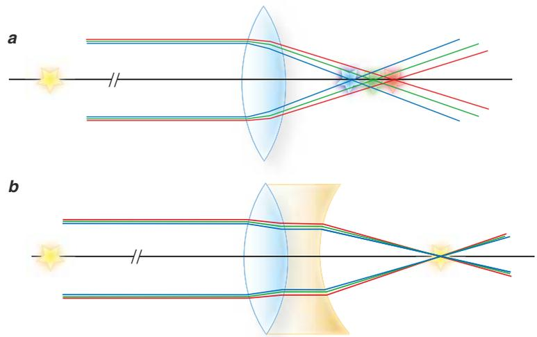
**L'aberration chromatique (a) : la déviation du rayon à travers la lentille varie en fonction de sa longueur d'onde (couleur) : les longueurs d'onde rouges sont moins déviées que les bleues. La solution de John Dollond (b) : il couple un verre peu dispersif (le crown-glass, lentille convexe à gauche) et un verre très dispersif (le flint-glass, lentille concave à droite) afin que leurs pouvoirs dispersifs se compensent.**
