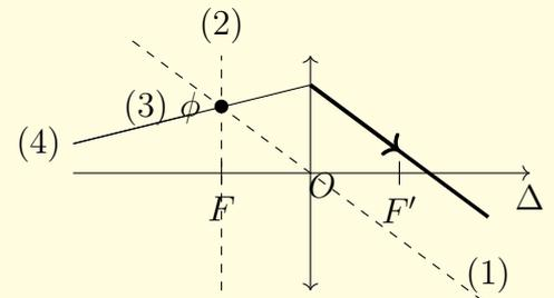
4. Le rayon émergent inconnu et le rayon auxiliaire émergent de la lentille parallèlement, donc ils proviennent d'un même plan focal objet : le foyer secondaire objet  $\phi$ .
