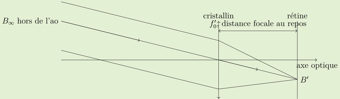
L'image de l'objet situé à l'infini (c'est-à-dire à distance très grande devant la taille de l'œil, à la distance focale du cristallin) se forme dans le plan focal image, donc la distance entre le cristallin et la rétine est égale à la distance focale du cristallin au repos.
