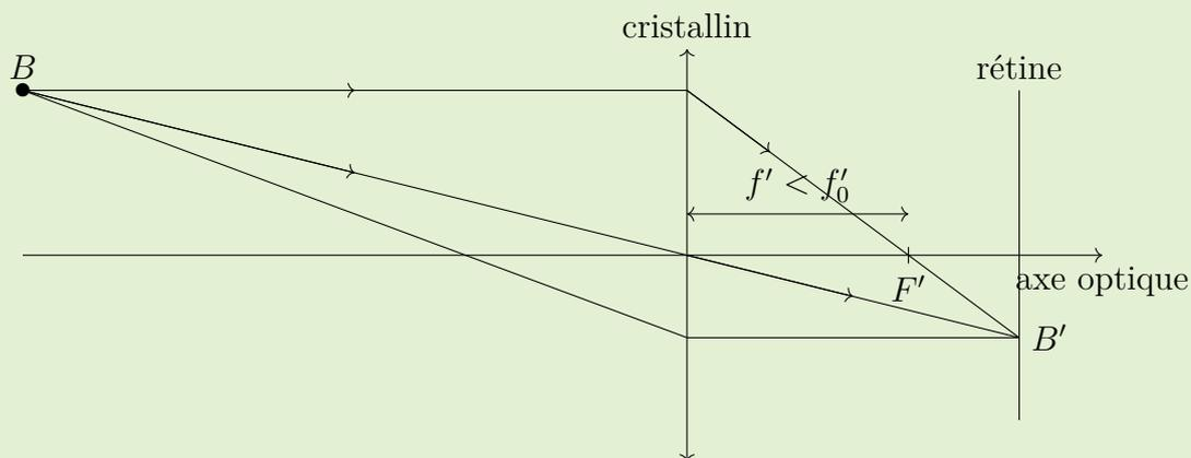
On peut, grâce au tracé de rayon, déterminer la position des foyers principaux de la lentille (cristallin), et constater que la distance focale est plus faible ici que dans le cas de l'observation d'un objet très éloigné.
