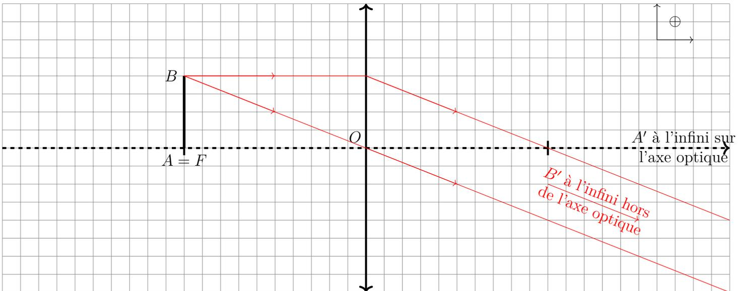
L'image est située à l'infini, avec  $A'$  à l'infini sur l'axe optique et  $B'$  à l'infini hors de l'axe optique.
