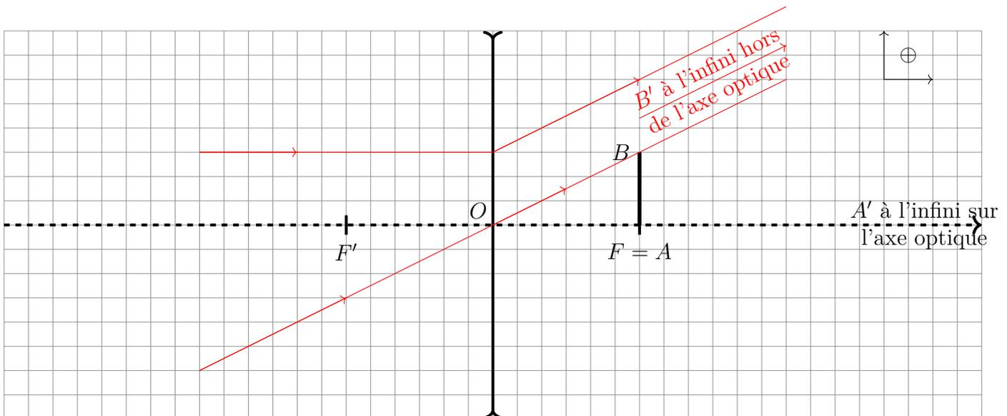
L'image est située à l'infini, avec  $A'$  à l'infini sur l'axe optique et  $B'$  à l'infini hors de l'axe optique.
