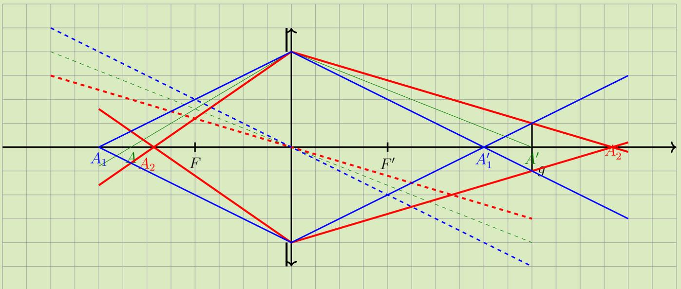
R2. Déterminer les positions des deux points image extrêmes,  $A'_1$  et  $A'_2$  qui apparaîtront nets sur l'écran.
