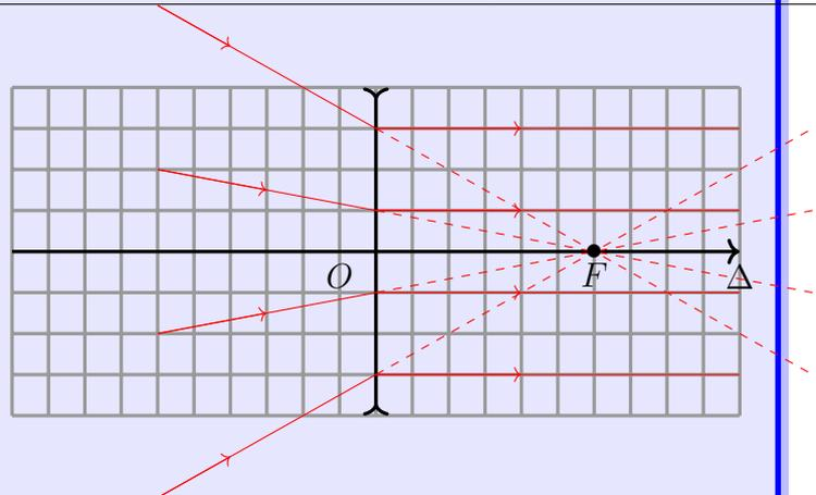
On appelle **plan focal objet**, le plan perpendiculaire à l'axe optique passant par  $F$ .
