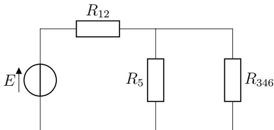
$R_{346}$  et  $R_5$  sont en parallèle, et sont équivalentes à une seule résistance  $R_{||}$  tq :  $\frac{1}{R_{||}} = \frac{1}{R_5} + \frac{1}{R_{346}}$
