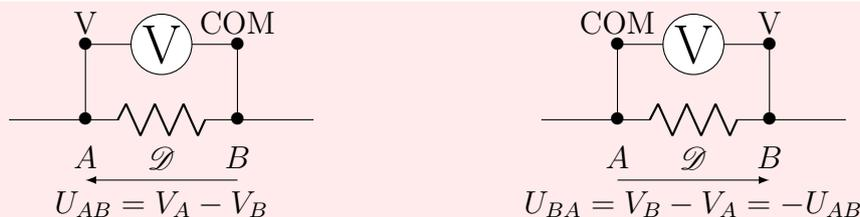
La tension mesurée à l'aide du voltmètre est la tension dont la pointe de la flèche est au niveau de la borne V et le bout de la flèche au niveau de la borne COM.
