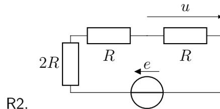
**Solution:** D'après la relation du pont diviseur de tension :  $u = \frac{R}{R + R}e = \frac{e}{2}$
