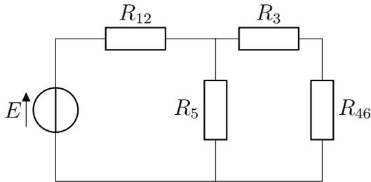
$R_3$  et  $R_{46}$  sont en série et peuvent être associées :  $R_{346} = R_3 + R_{46}$
