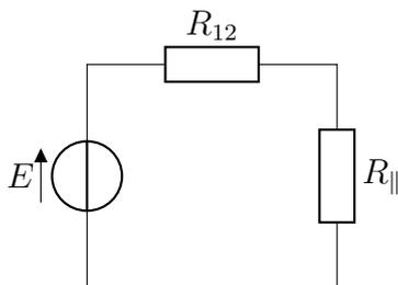
On associe les deux résistances  $R_{12}$  et  $R_{||}$  en série :  $R_{\text{éq}} = R_{12} + R_{||}$
