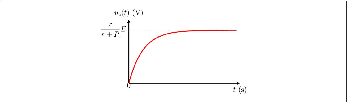
R7. On appelle temps de réponse  $t_r$  à 5% le temps que met la tension pour atteindre la valeur finale à 5% près : c'est le temps  $t_r$  tel que  $|u_C(t_r) - u_{C,finale}| = 0,05|u_{C,finale}|$ . Déterminer ce temps de réponse à 5% .
