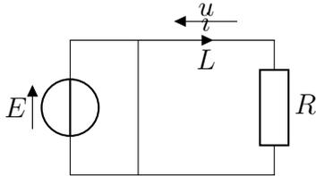
$u$  est la tension aux bornes d'un fil :  $u(\infty) = 0$
