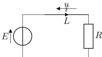
$u$  est la tension aux bornes d'un fil :  $u(t < 0) = 0$
