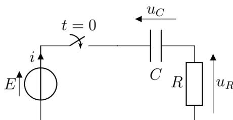
On considère le circuit ci-contre, où  $E$  est la force électromotrice constante du générateur idéal de tension.
