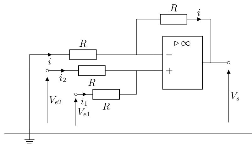
Au niveau de la borne inverseuse :  $i = \frac{0 - V^-}{R} = \frac{V^- - V_s}{R}$ , soit  $V_s = 2V^-$
