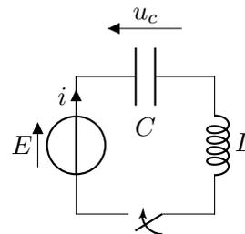
Q10. Établir l'équation différentielle vérifiée par la tension  $u_c$  aux bornes du condensateur. Identifier la pulsation propre du circuit.
