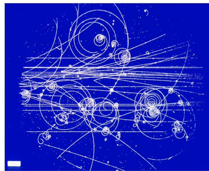
Une image prise dans une chambre à bulles montrant les trajectoires des particules courbées par un champ magnétique. Le sens de la courbure donne le signe de la charge de la particule, et le rayon de courbure mesure la quantité de mouvement. (Cern)
