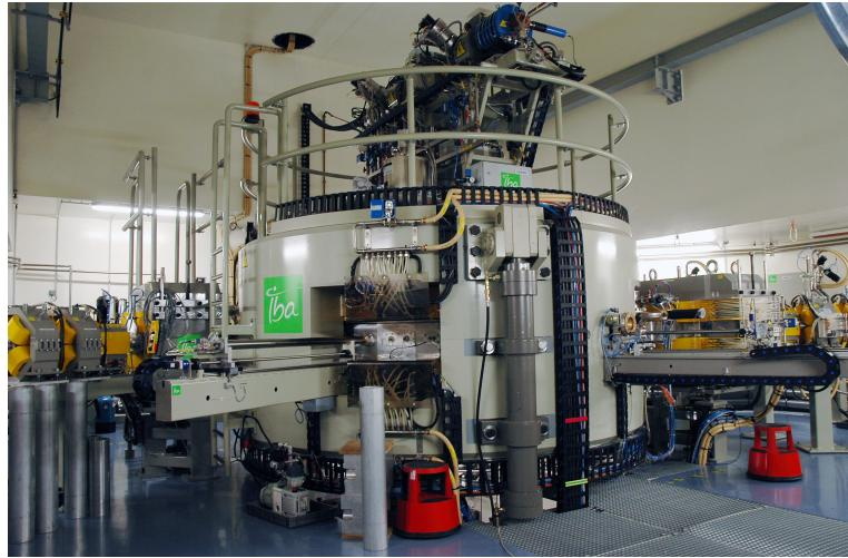
Cyclotron 70 MeV installé à l'Université de Nantes (France) en 2008. Ce cyclotron est conçu pour accélérer des protons, des deutons (=noyau de l'atome de deutérium) et des particules alpha.
