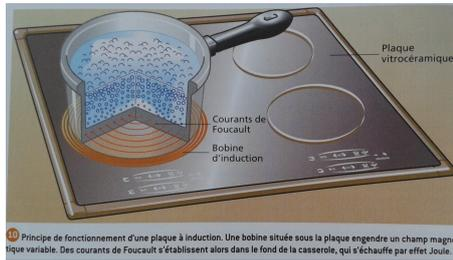
Principe de fonctionnement d'une plaque à induction. Une bobine située sous la plaque engendre un champ magnétique variable. Des courants de Foucault s'établissent alors dans le fond de la casserole, qui s'échauffe par effet Joule.
