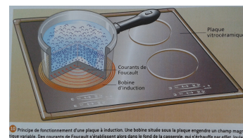
Principe de fonctionnement d'une plaque à induction. Une bobine située sous la plaque engendre un champ magnétique alternatif. Des courants de Foucault se réalisent alors dans le fond de la casserole, qui s'échauffe par effet Joule.
