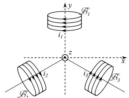
Le champ magnétique créé par la bobine  $j$  s'écrit  $\vec{B}_j = \pm K i_j \vec{u}_j$ , avec  $\vec{u}_j$  est le vecteur unitaire de l'axe de la bobine. Le signe sera choisi par règle de la main droite. La constante  $K$  est identique pour les trois bobines.
