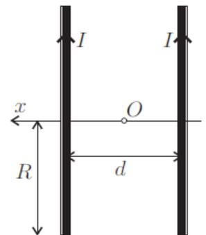
On montre qu'en un point  $M$  situé à l'abscisse  $x$ , sur l'axe  $Ox$ , le champ magnétique  $\vec{B}$  créé par les bobines s'écrit :  $\vec{B}(x) = N\vec{B}_0 \left\{ \left[ 1 + \left( \frac{x}{R} - \frac{1}{2} \right)^2 \right]^{-3/2} + \left[ 1 + \left( \frac{x}{R} + \frac{1}{2} \right)^2 \right]^{-3/2} \right\}$
