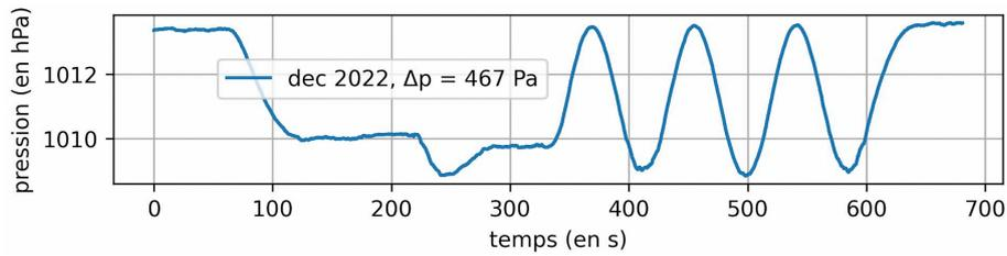
La différence de pression mesurée lors des oscillations est  $\Delta p = 467 \text{ Pa}$ .
