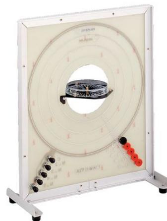
On note  $\vec{B}_{Th}$  le champ magnétique terrestre horizontal et  $\vec{B}_b$  le champ magnétique créé par la bobine lorsqu'elle est alimentée.
