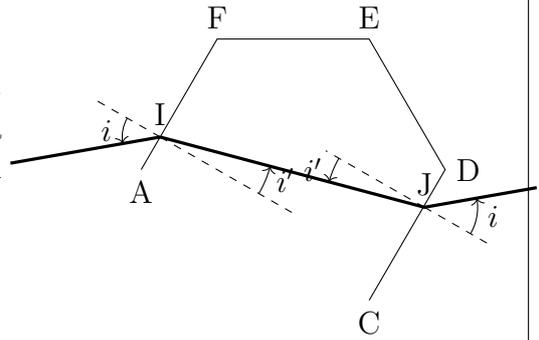
On considère le rayon émergent par la face  $(DE)$ . Les faces  $(AF)$  et  $(DE)$  sont analogues aux faces d'un prisme de sommet  $G$ , d'angle au sommet  $\beta$  égal à  $60^\circ$  et d'indice optique égal à celui de la glace, à savoir  $n_g$  (voir figure 3).
