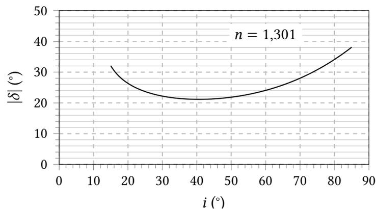
FIGURE 4 – Valeur absolue de la déviation du rayon lumineux en fonction de l'angle d'incidence.
