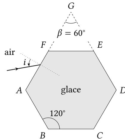
FIGURE 2 – Représentation de la section droite d'un cristal de glace et d'un rayon lumineux incident sur la face ( $AF$ ) du cristal.
