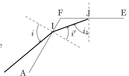
La somme des angles (définis dans le sens trigonométrique positif) dans le triangle  $FIJ$  vaut  $180^\circ$ .
