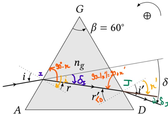
FIGURE 3 – Déviation du rayon lumineux incident par le prisme  $(ADG)$  d'indice optique  $n_g$
