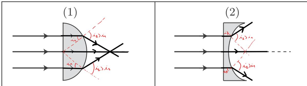
FIGURE 1 – Lentilles plan convexe (1) et plan concave (2)
