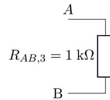
Avec  $\frac{1}{R_{AB,3}} = \frac{2}{2 \text{ k}\Omega}$ , soit  $R_{AB,3} = 1 \text{ k}\Omega$
