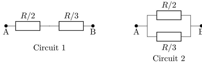
**Solution:** Circuit 1 :  $R_1 = \frac{R}{2} + \frac{R}{3}$ , donc  $R_1 = \frac{5R}{6}$
