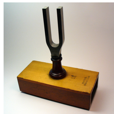
FIGURE 1 – Diapason sur son résonateur
