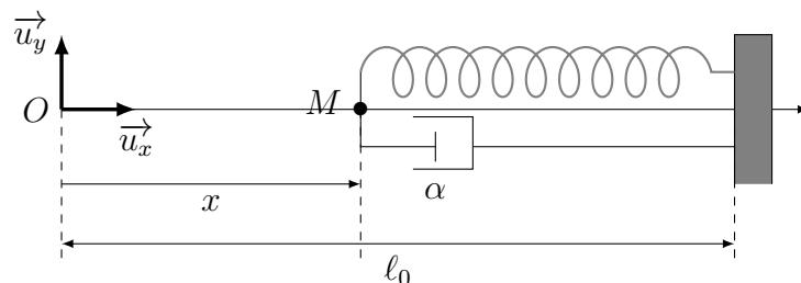
Cette masse est reliée à un ressort de longueur à vide  $\ell_0$  et de raideur  $k$  et à un amortisseur fluide de constante  $\alpha$  dont l'action est modélisée par la force  $\vec{f} = -\alpha \vec{v}$ .
