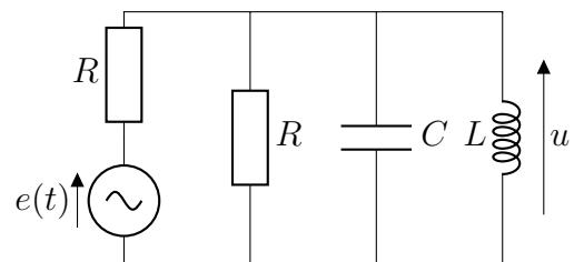
**Q1. Déterminer** les expressions de  $u$  à basse et haute fréquence à partir du comportement asymptotique du circuit.
