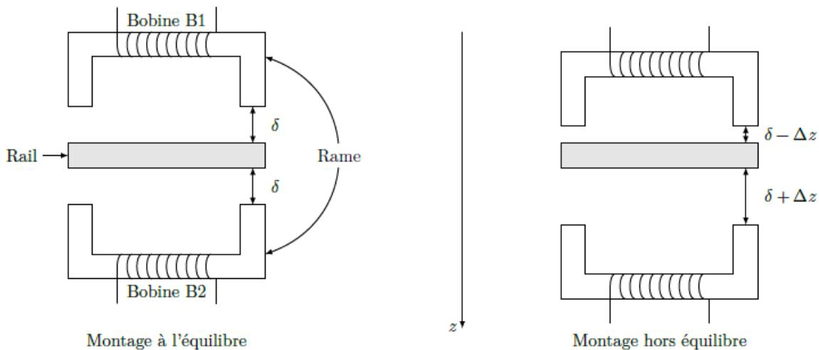
On envisage une variation  $\Delta z$  de la position du train par rapport à la position d'équilibre  $z_e = \delta$ , en considérant  $\Delta z \ll \delta$ , on montre que  $L_1 = L_e \left(1 + \frac{\Delta z}{\delta}\right)$  et  $L_2 = L_e \left(1 - \frac{\Delta z}{\delta}\right)$ .
