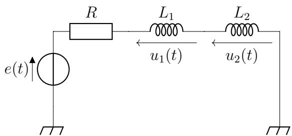
Q1. Déterminer les expressions des tensions électriques complexes  $u_1$  et  $u_2$  en fonction de  $R$ ,  $L_1$ ,  $L_2$ ,  $\omega$  et  $e(t)$ .
