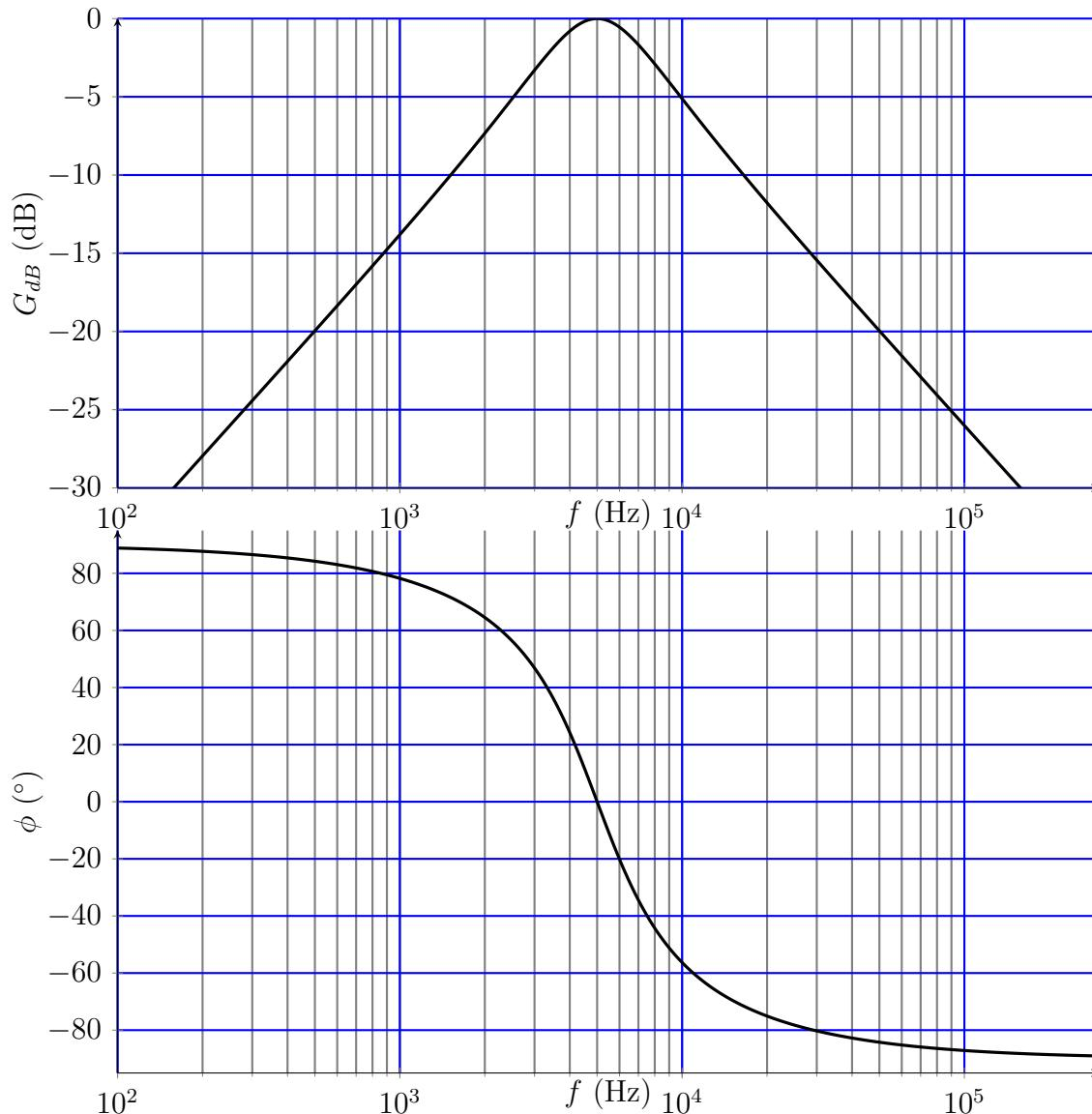
Q6. À partir de la fonction de transfert, déterminer les équations des asymptotes au diagramme de Bode en gain. Comparer au diagramme fourni.
