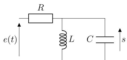
Q1. Par analyse asymptotique du circuit, déterminer la nature du filtre.
