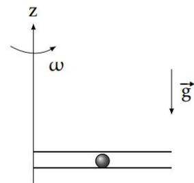
La bille de masse m est assimilée à un point matériel M. Elle est lâchée, à l'instant  $t = 0$  d'une distance  $r_0$  de l'axe de rotation et sans vitesse initiale par rapport au tube. On néglige les frottements et on étudie le mouvement dans le référentiel du laboratoire supposé galiléen.
