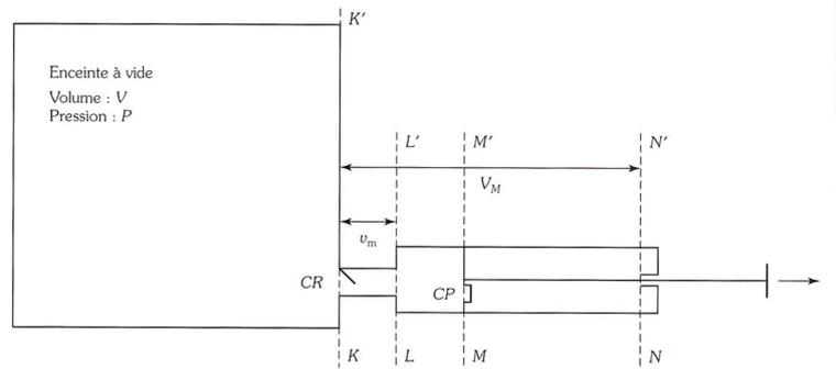
*Schéma de principe de la pompe à piston raccordée à l'enceinte (attention, sur ce schéma, les proportions ne sont pas respectées).*
