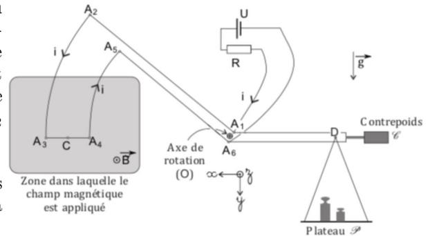
1. Montrer que, lorsque l'équilibrage à vide est réalisé, le centre de masse,  $G$ , des parties mobiles de la balance est en  $O$ .
