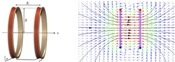
On peut modéliser les bobines de Helmholtz par deux associations de  $N$  spire confondues parcourues par un même courant  $i$ , de même rayon  $R$  et séparées d'une distance  $R$ : le champ créé par l'une d'elle sur l'axe ( $Ox$ ) à une distance  $x$  du centre du dispositif vaut :
