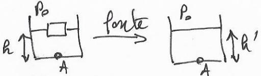
Le fond du verre "supporte" la masse de la colonne d'air et d'eau au dessus d'elle, indépendante de l'état physique de l'eau  $\Rightarrow P_A \text{ avant} = P_A \text{ après} \Leftrightarrow P_0 + \rho g h = P_0 + \rho g h'$
