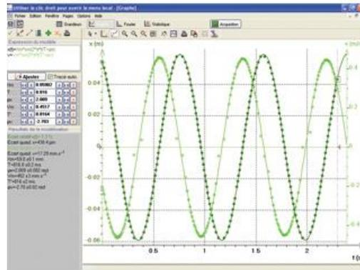
La tension mesurée est proportionnelle à l'allongement du ressort. Si on note  $x(t)$  l'allongement du ressort,  $x(t)$  est une fonction harmonique (ou sinusoïdale) du temps.
