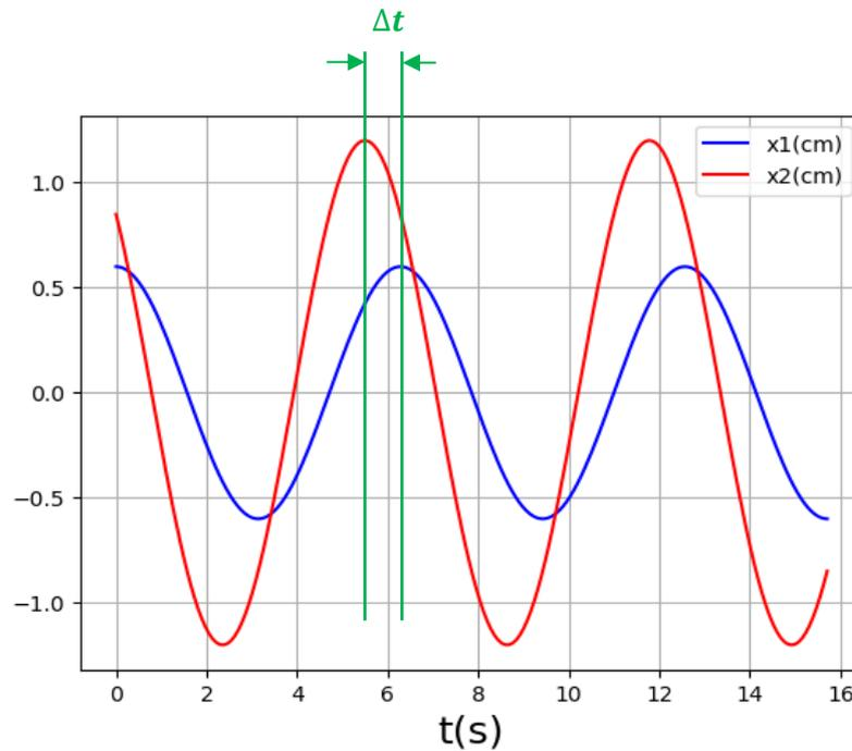
On peut mesurer les phases à l'origine des temps de  $x_1(t)$  et de  $x_2(t)$  comme précédemment puis calculer  $\varphi_{1/2} = \varphi_1 - \varphi_2$ . En notant qu'en abscisse on mesure des temps, on peut également mesurer le décalage temporel  $\Delta t$  entre les deux signaux puis en déduire le déphasage en posant que :
