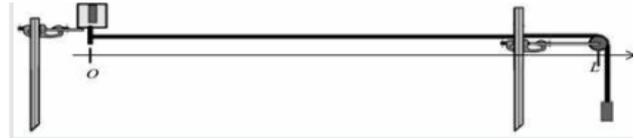
On constate qu'en fonction de la fréquence, on observe un, ou plusieurs fuseaux en accord avec ce qui a été établi précédemment. Pour  $n$  fuseaux, on vérifie que la fréquence  $f_n = n \cdot f_1$ .
