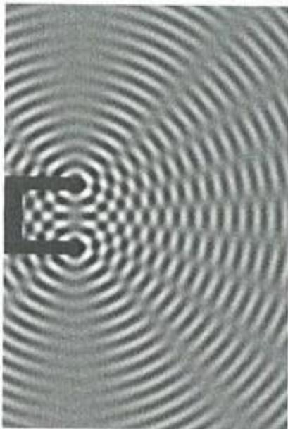
Dispositif des trous d'Young : la lumière émise par une source cohérente (Laser He-Ne) éclaire une plaque opaque dans laquelle deux fentes laissent passer la lumière. On observe des zones où la lumière est maximale et des zones où la lumière est nulle : on observe des interférences lumineuses. Ceci constitue ce que l'on appelait autrefois le « Paradoxe de la lumière : lumière plus lumière donne de l'obscurité... ».
