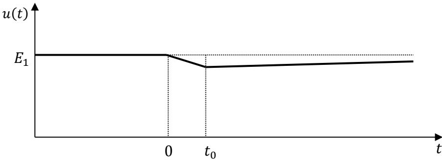
6) A.N ; : avec  $R = 100 \Omega$ ,  $C = 1,00 mF$ ,  $\frac{\Delta e}{E_1} = 0,100$  et  $t_0 = 1,00 ms$  ,  $\frac{|\Delta u|}{E_1} = \frac{t_0 \frac{\Delta e}{E_1}}{R \cdot C} = \frac{t_0 \frac{0,100}{E_1}}{100 \cdot 10^{-6}}$  :
