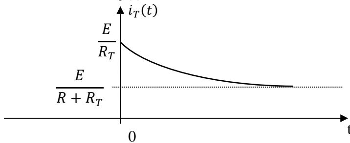
A la fermeture de l'interrupteur K', il apparaît une discontinuité du courant dans le tube à gaz au voisinage de  $t = 0$  d'autant plus grande que  $R$  est grand devant  $R_T$ . Cette brusque variation d'intensité provoque le flash (ou l'éclair) de l'appareil photo
