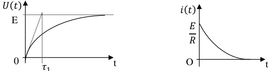
La tangente à  $U(t)$  en  $t = 0$  coupe  $E$  à  $t = \tau_1$  ce qui permet de déterminer la valeur du temps caractéristique  $\tau_1$ . On peut également déterminer  $\tau_1$  en utilisant le fait que  $U(\tau_1) = 0,63 \cdot E$ .
