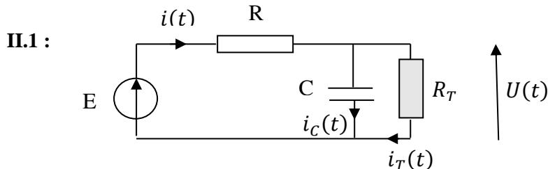
Nous savons qu'il n'y a pas de discontinuité de la tension aux bornes du condensateur donc  $U(0^+) = U(0^-) = E$ . Avec  $U(0^+) = R_T \cdot i_T(0^+) = E$  ;  $i_T(0^+) = \frac{E}{R_T}$  Pour  $t \rightarrow \infty$ ,  $i_C(\infty) = C \frac{dU(t)}{dt} = 0$  : le condensateur est équivalent à un interrupteur ouvert et  $i(\infty) = i_T(\infty) = \frac{E}{R+R_T}$
