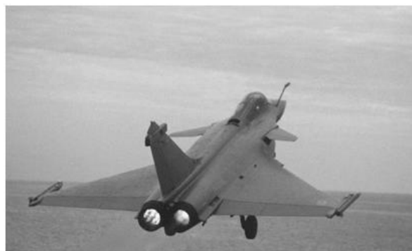
Rafale propulsé par deux moteurs Snecma M88
