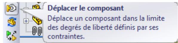
A l'aide de l'outil Déplacer un composant, vérifier la coaxialité en **A** du **Bâti 1** et du **Bras motorisé 2**.
