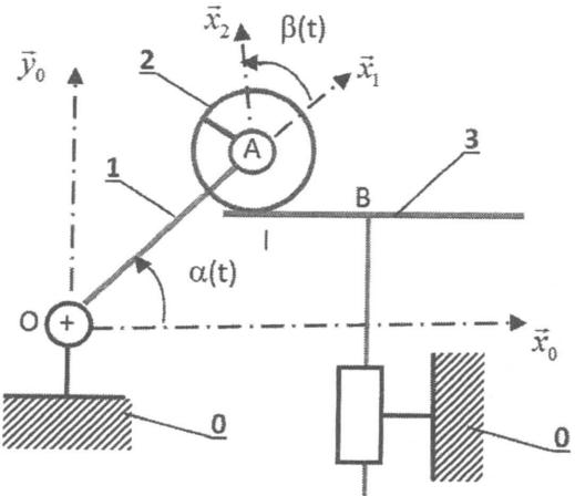
Le mouvement d'entrée est imposé par une rotation alternative de l'arbre 1. Le mouvement de sortie est une translation du coulisseau 3 dont le plan supérieur est de longueur  $2*b$  et de milieu le point B. Un galet 2 de rayon R assure la transmission de puissance via le contact au point I avec le coulisseau 3.
