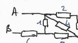
$$\begin{aligned} \text{Dans l'ordre: } 2, 3 &\text{ en série} \rightarrow 2R, \text{ en parallèle avec } 4 \rightarrow \frac{2R^2}{R+2R} = \frac{2}{3}R, \text{ en série avec } 5 \rightarrow \frac{5}{3}R, \\ \text{en parallèle avec } 1 &\rightarrow \frac{\frac{5}{3}R^2}{\frac{5}{3}R+R} = \frac{5}{8}R, \text{ en série avec } 6 \rightarrow \frac{13}{8}R \end{aligned}$$
