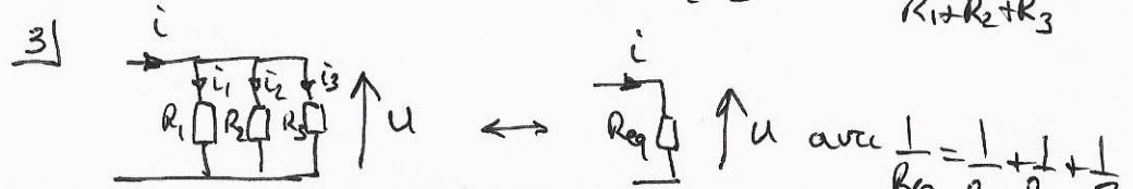
$$\text{Démon: } i = \frac{U}{\text{Req}} = i_1 + i_2 + i_3 = \frac{U}{R_1} + \frac{U}{R_2} + \frac{U}{R_3}, \text{ d'où le résultat } \frac{1}{\text{Req}} = \frac{1}{R_1} + \frac{1}{R_2} + \frac{1}{R_3}$$
