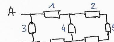
$$\begin{aligned} \text{Dans l'ordre: } 2, 3, 4 &\text{ en série} \rightarrow 3R, \text{ en parallèle avec } 5 \rightarrow \frac{3R^2}{3R+R} = \frac{3}{4}R, \text{ en série avec } 6 \rightarrow 2R + \frac{3}{4}R = \frac{11}{4}R, \\ \text{avec } 1, 7 &\rightarrow 2R + \frac{3}{4}R = \frac{11}{4}R, \text{ en parallèle avec } 3 \rightarrow \frac{11R}{4(1+\frac{11}{4})} = \frac{11}{15}R \end{aligned}$$
