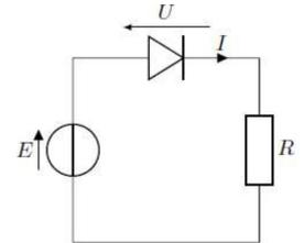
**Q1** Placer ci contre les appareils de mesure nécessaires pour mesurer la tension aux bornes de la diode et l'intensité du courant le circuit afin de représenter la caractéristique  $I = f(U)$
