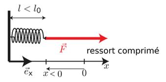
La force exercée sur un point  $M$  accroché à l'extrémité est proportionnelle à l'allongement  $x = l - l_0$  du ressort :
