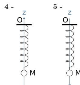
**Rép :** 1 :  $\vec{F} = -k(x - l_0)\vec{e}_x$ ; 2 :  $\vec{F} = k(x - l_0)\vec{e}_x$ ; 3 :  $\vec{F} = -k(x - x_H - l_0)\vec{e}_x$ ; 4 :  $\vec{F} = k(z - l_0)\vec{e}_z$ ; 5 :  $\vec{F} = -k(z - l_0)\vec{e}_z$ ;
