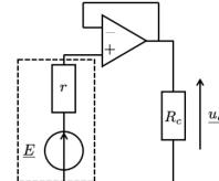
Intérêt en pratique : Le suiveur transmet intégralement une tension sans appeler aucun courant :
