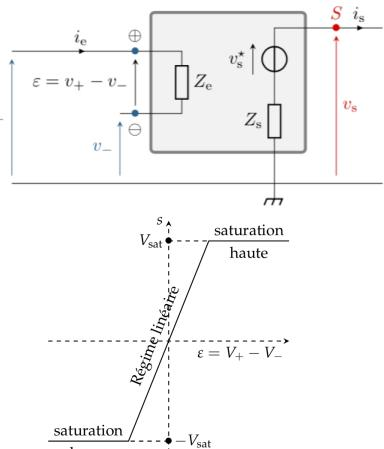
Les résistances d'un ALI réel sont : en entrée  $Z_e \simeq 10^{12}\Omega$  et en sortie  $Z_s \simeq 10\Omega$ .
