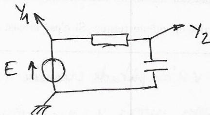
**Q2** Placer sur le schéma précédent les voies de l'oscilloscope afin de visualiser la tension délivrée par le GBF en voie CH1 et la tension aux bornes du condensateur en voie CH 2 .
