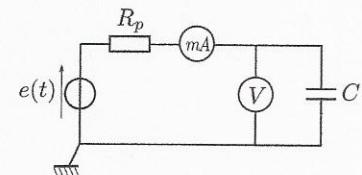
**Q12** Régler le GBF pour qu'il délivre 4V en valeur efficace. Réaliser le montage précédent en prenant une résistance de protection ( $R_p$ ) de  $1\text{k}\Omega$ . Mesurer les valeurs de  $V_{\text{eff}}$  et  $I_{\text{eff}}$  pour quelques valeurs de fréquence comprises entre 50 Hz et 10 kHz. Déduire, en précisant la méthode utilisée, la valeur de  $C$ .
