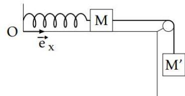
Rép : Appliquer le PFD à  $M'$  puis  $M$ , utiliser que le fil est inextensible ;  $x = x_{eq} + (x_0 - x_{eq}) \cos \omega t$ , avec  $\omega = \sqrt{k/(m + m')}$  et  $x_{eq} = \ell_0 + m'g/k$
