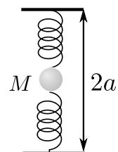
Rép :  $l_{1/2} = a \pm \frac{mg}{2k}$ , oscillations à  $\omega_1 = \sqrt{\frac{2k}{m}}$  et  $\omega_2 = \sqrt{\frac{2k(1 - \ell_0/a)}{m}}$
