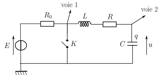
**Q2** Réaliser le montage avec  $R_0 = 1\text{k}\Omega$  (résistance de protection),  $R = 20\Omega$  (boîtes de résistances), une bobine L de 1000 tours (en cuivre, sans noyau de fer) (ou de 10 mH selon le matériel),  $C = 0,5\mu\text{F}$  et une alimentation stabilisée délivrant 4V.
