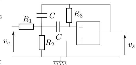
**Q5** : Déterminer la bande passante de ce filtre et conclure quant à son utilisation par rapport à notre expérience.
