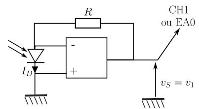
On a donc une tension de sortie directement proportionnelle au flux lumineux reçu.
