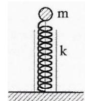
**Rép :** On peut poser  $X = x - x_e$  d'où  $X = -a \cos \sqrt{\frac{k}{m}} t$ ;  $T = 2\pi \sqrt{\frac{m}{k}}$ ;  $a_{\min} = \frac{mg}{k}$
