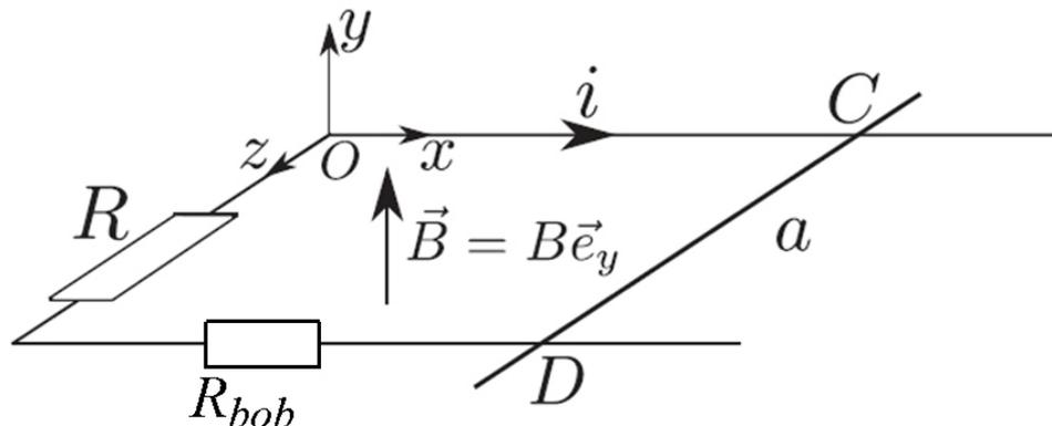
Le champ magnétique extérieur  $\vec{B} = B\vec{e}_y$ , avec  $B > 0$  est stationnaire et uniforme à travers le circuit.
