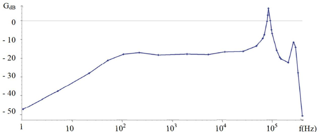
4. Ce diagramme de Bode, en amplitude, correspond-il à la fonction de transfert déterminée précédemment ? Si non, proposer une limitation à votre modèle en précisant en une ou deux phrases le(s) phénomène(s) physique(s) présent(s) et non décrit(s) par votre modèle.
