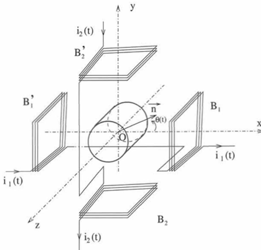
Chaque association de bobines forme un circuit fermé sur une charge de résistance  $R_c$ .
