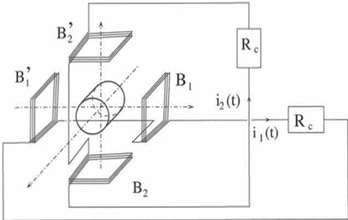
Dans ce problème, nous ne nous intéresserons qu'au fonctionnement de l'alternateur en régime permanent mécanique, c'est-à-dire lorsque la vitesse de rotation du rotor  $\Omega$  est une constante positive. L'origine du temps est choisie de telle sorte que  $\theta(t) = \Omega t$ .
