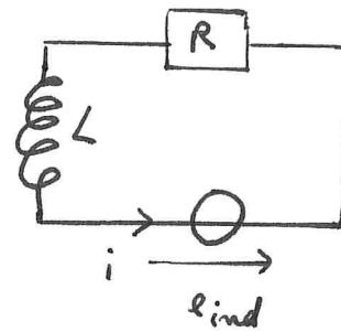
avec  $\varepsilon_{\text{ind}} = -\dot{\phi}_{\text{ext}}$  et  $\dot{\phi}_{\text{ext}} = a z B$  (\*)
