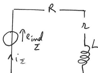
$$e_{\text{ind}\Sigma} = R i_{\Sigma} + r i_{\Sigma} + L \frac{di_{\Sigma}}{dt}$$
