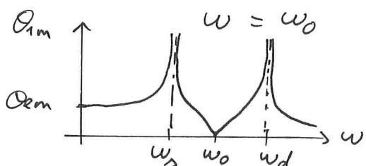
2 osc. couplés forment un système avec 2 pulsations de résonance et 1 pulsation d'antirésonance.
