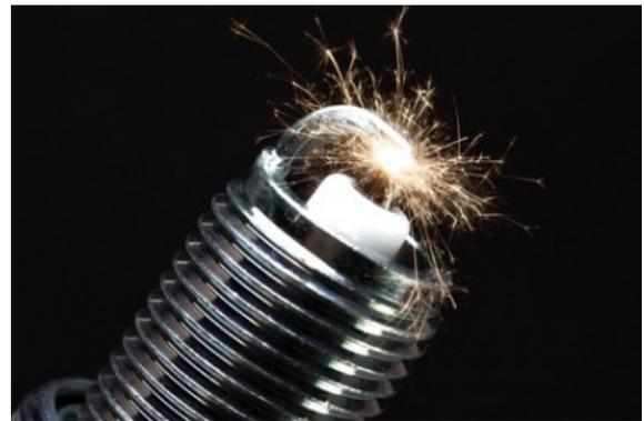
Le mélange gazeux air-essence est un isolant électrique. Toutefois, s'ils sont soumis à de très fortes tensions, les électrons des molécules constituant le mélange gazeux peuvent être arrachés à leur orbite de valence. Le mélange gazeux devient alors conducteur et le passage d'un courant électrique dans le gaz provoque une étincelle.
