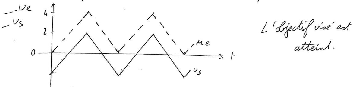
10.  $f_2 = 1 Hz$  donc le fondamental et les principales harmoniques sont dans la zone de pente  $+20 dB/dec$ : le filtre est alors un dérivateur: en sortie il y a ~~une succession d'impulsions~~ sans composante continue. un signal créneau
