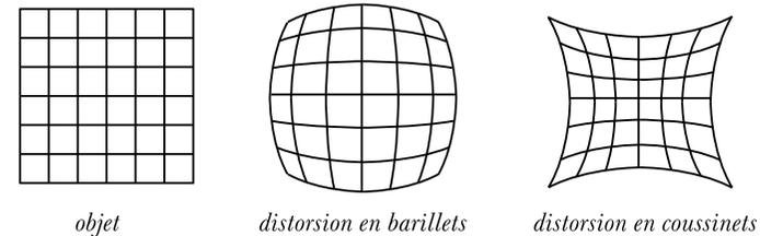
Deux effets différents de la distorsion produite par un système optique : en barillets et en coussinets
