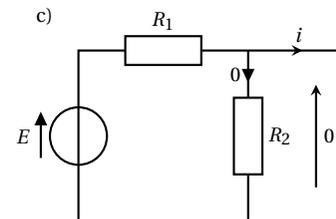
En régime permanent, la bobine se comporte comme un fil. La résistance  $R_2$  est court-circuitée donc la tension à ses bornes est nulle. D'après la loi d'Ohm, le courant qui la traverse est nul aussi. En appliquant la loi des mailles, on trouve finalement que  $i = \frac{E}{R_1}$ .
