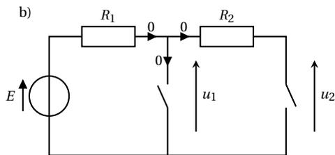
D'après la loi des nœuds, le courant qui circule dans  $R_1$  est nul. Les tensions aux bornes des deux résistances sont nulles donc  $u_1 = u_2 = E$ .
