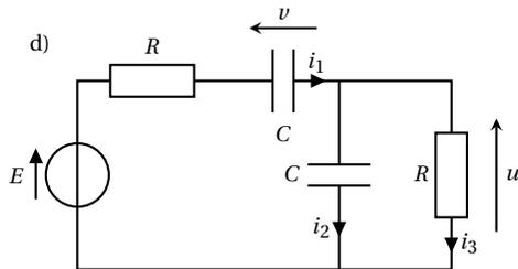
Par continuité,  $u(0^+) = u(0^-) = 0$  et  $v(0^+) = v(0^-) = 0$ . On en déduit que  $i_3(0^+) = 0$  (loi d'Ohm), puis  $i_1(0^+) = i_2(0^+)$  (loi des nœuds).
