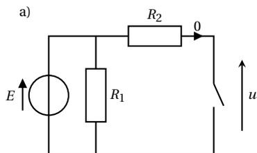
En régime permanent, le condensateur se comporte comme un interrupteur ouvert. D'après la loi d'Ohm, la tension aux bornes de  $R_2$  est nulle. Par application de la loi des mailles, on trouve  $u = E$ .
