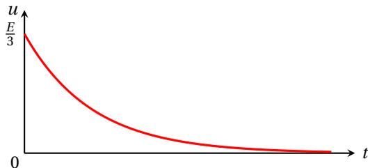
6. Au cours de la décharge, le condensateur cède à la résistance une énergie
