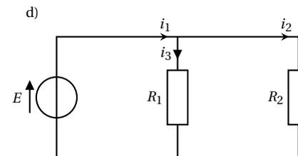
La tension aux bornes de chaque résistance vaut  $E$ . D'après la loi d'Ohm,  $i_2 = \frac{E}{R_2}$  et  $i_3 = \frac{E}{R_1}$ . En utilisant la loi des nœuds, on en déduit que  $i_1 = E \left( \frac{1}{R_1} + \frac{1}{R_2} \right)$ .
