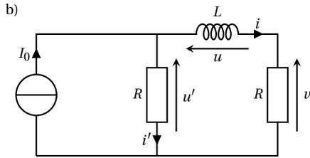
Par continuité de l'intensité du courant qui circule dans une bobine,  $i(0^+) = i(0^-) = 0$ . On en déduit que  $i'(0^+) = I_0$  (loi des nœuds) puis que  $u'(0^+) = RI_0$  (loi d'Ohm).
