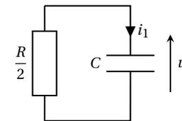
Une fois l'interrupteur ouvert, le circuit est un RC série en régime libre. L'équation différentielle vérifiée par  $u(t)$  est la suivante :
