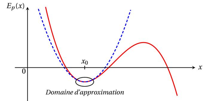
Au voisinage d'une position d'équilibre stable  $x_0$ , on peut assimiler le système à un oscillateur harmonique de pulsation  $\omega_0$  telle que  $m\omega_0^2 = \left(\frac{d^2E_p}{dx^2}\right)_{x_0}$
