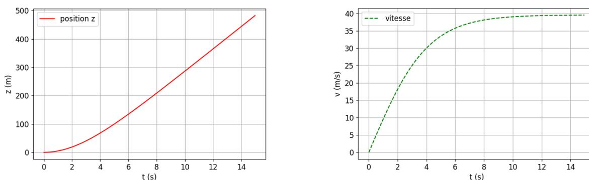
**Figure 2** : position  $z(t)$  et vitesse  $v(t)$  au cours de la chute d'un grêlon, courbes obtenues par résolution numérique
